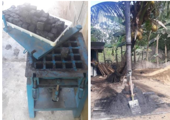
Gambar 11. Alat press briket arang sekam tipe semi hidrolisk vertikal (kiri), dan alat pembuat arang sekam type chimney (kanan)
