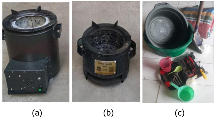
Gambar 12. Kompor briket arang sekam dengan kipas semi elektrik (a) dan non elektrik (b) serta peralatan pendukung untuk pembuatan Briket arang sekam (c)
